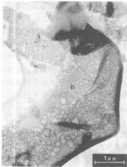
图 1 60keV 的 Ni + 和 Ar + 分别注入石墨产生含 Ar 泡碳薄片的 TEM 像 先注入 Ni + 再注入 Ar + ,剂量均为 10 18 /cm 2 。
